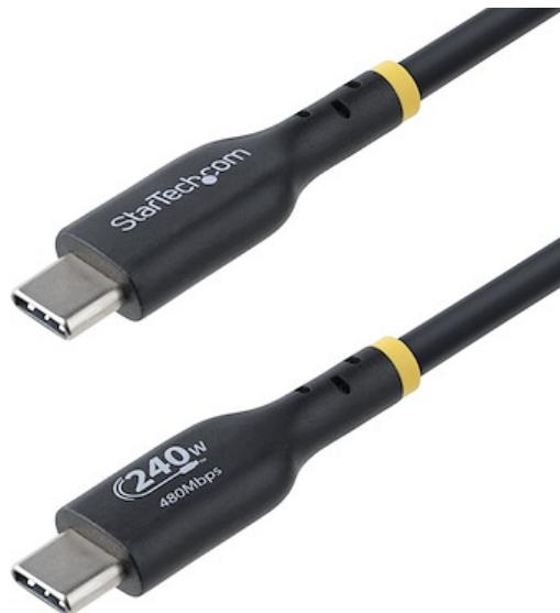
Conecte un cargador a un dispositivo USB Power Delivery (PD) 3.1, utilizando este cable de carga USB-C. Este cable facilita hasta 240 W de suministro de energía USB-C Extended Power Range (EPR) y una salida de 5A para una carga rápida. Es compatible con el rendimiento USB 2.0 (480 Mbps) para la transferencia de ficheros.
