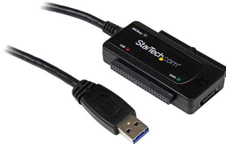
Das USB 3.0-auf-IDE/SATA-Adapterkabel USB3SSATAIDE verbindet jede standardmäßige 2,5-Zoll- oder 3,5-Zoll-SATA- oder -IDE-Festplatte über einen verfügbaren USB 3.0-Port (abwärts kompatibel mit USB 2.0) mit einem Computer. Mit dem Adapter können Sie ein reines Laufwerk ohne Gehäuse anschließen und sparen so Zeit und Mühe.
