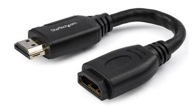
Este cable extensor del puerto HDMI de alta velocidad evita desgastes del puerto HDMI de su monitor u otros dispositivos, ya que extiende el alcance del puerto más allá del propio puerto, para permitir una conexión más flexible. Este cable extensor de puerto es compatible con todas las especificaciones HDMI 2.0, incluyendo las correspondientes a resoluciones de hasta 4K (60Hz), así como a ancho de banda de hasta 18Gbps.
