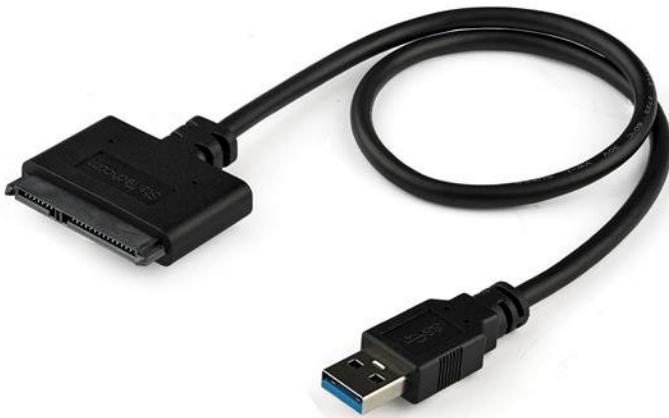
Este cable SATA a USB es un adaptador de unidad externa que le ofrece acceso rápido y fácil a una unidad SATA, a través del puerto USB-A de un ordenador portátil.
