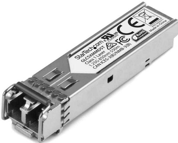
Das GLCSXMMDS ist ein Cisco GLC-SX-MMD-kompatibles Glasfaser-Transceiver-Modul, das speziell für die Zusammenarbeit mit Cisco®-Switches und -Router entwickelt, programmiert und getestet wurde. Es liefert zuverlässige 1-GbE-Konnektivität über Glasfaserkabel für 1000BASE-SX-konforme Netzwerke mit einer maximalen Entfernung von bis zu 550 m.
