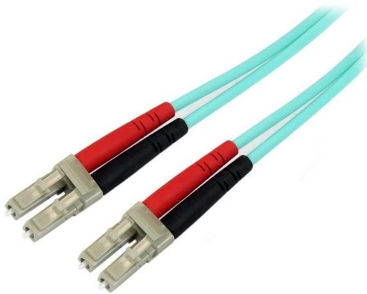
Le câble turquoise à fibre optique optimisée laser multimode A50FBLCLC3 de 3 m 850 nm comprend une fibre optique de 50/125 microns pour des transferts de données haute vitesse et à large bande passante sur les réseaux Ethernet 10 Gb et Fiber Channel. Cela en fait le câble idéal pour les acheminements de câble à fibre optique entre plusieurs commutateurs, hubs et routeurs d'infrastructure, ainsi que de l'équipement réseau plus haut de gamme.
