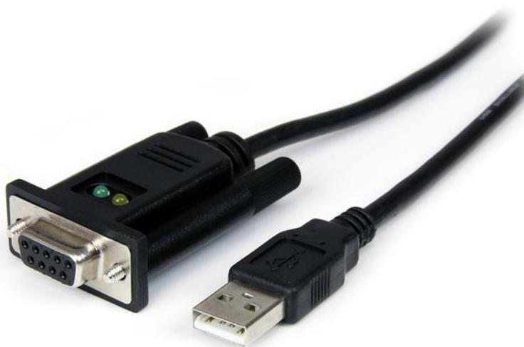
Il cavo adattatore seriale USB FTDI a null modem (1 porta) ICUSB232FTN consente di convertire una porta USB 1.1 o 2.0 in una porta DB9 seriale null modem RS232, risolvendo direttamente i conflitti DCE/DTE, senza che siano necessari altri cavi seriali incrociati o adattatori.
