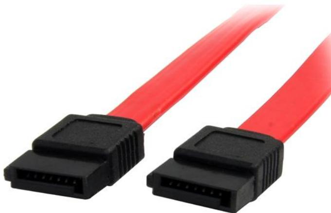
El cable serial ATA SATA12 incluye dos receptáculos para datos, de 7 pines, y soporta completamente el ancho de banda SATA 3.0 de hasta 6 Gpbs cuando se utiliza con unidades SATA 3.0 compatibles.
