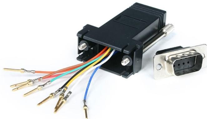
L'adattatore modulare GC98MF presenta un connettore maschio DB9 e un connettore femmina RJ45. Utilizzato per connessioni modulari RS232, RS422 e RS485, l'adattatore converte una connessione DB9 femmina in una connessione RJ45 femmina. L'adattatore permette configurazioni personalizzate dei contatti seriali.
