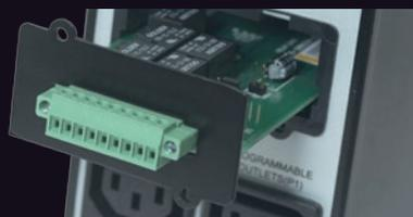
Per la comunicazione con server IBM AS400 o per l'integrazione in impianti di manovra industriali è possibile espandere XANTO con una scheda AS400/relè opzionale.
