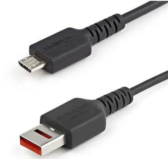
Este cable USB-A a USB micro-B, con bloqueador de datos, le permite cargar de forma segura su dispositivo, ya que establece una conexión exclusiva de alimentación entre su dispositivo y el sistema anfitrión o fuente de alimentación. Equipado con un conector USB-A macho que no es para datos, con un diseño único recortado, este cable seguro evita ataques de malware y robo de datos, además de que proporciona una forma segura de cargar sus dispositivos móviles.
