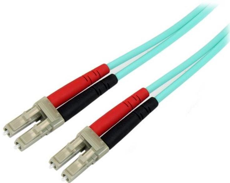
El cable de fibra óptica Aqua, de 1 metro, 850 nm, multimodo con optimización láser (LOMMF), modelo A50FBLCLC1, incluye fibra óptica de 50/125 micrones para la transmisión de datos a alta velocidad, alto ancho de banda, a través de redes de canales de fibra óptica y Ethernet de 10 Gigabits: la solución perfecta para tramos de cables de fibra óptica entre varios conmutadores, concentradores y enrutadores base, así como equipos de red de alta gama.
