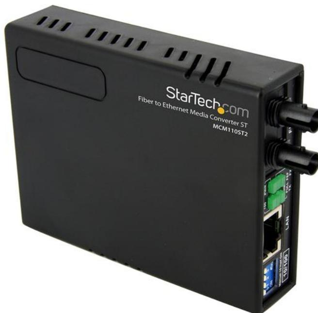
Le convertisseur Ethernet fibre optique multimode ST 10/100 MCM110ST2EU (2 km) crée une liaison Ethernet-fibre optique économique, qui convertit de façon transparente vers/depuis des signaux Ethernet 10Base-T ou 100Base-Tx et optiques 100Base-Fx pour l'extension d'une connexion réseau Ethernet sur une infrastructure en fibre optique multimode.
