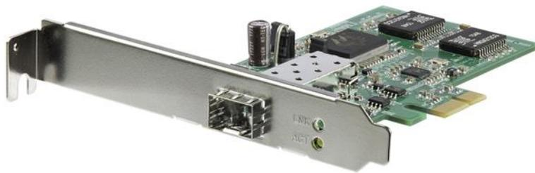
La tarjeta de red PCI Express de Fibra Óptica Gigabit, modelo PEX1000SFP2, permite la conexión directa de un PC basado en PCI Express con una red de fibra óptica mediante un SFP Gigabit SFP de su preferencia.
