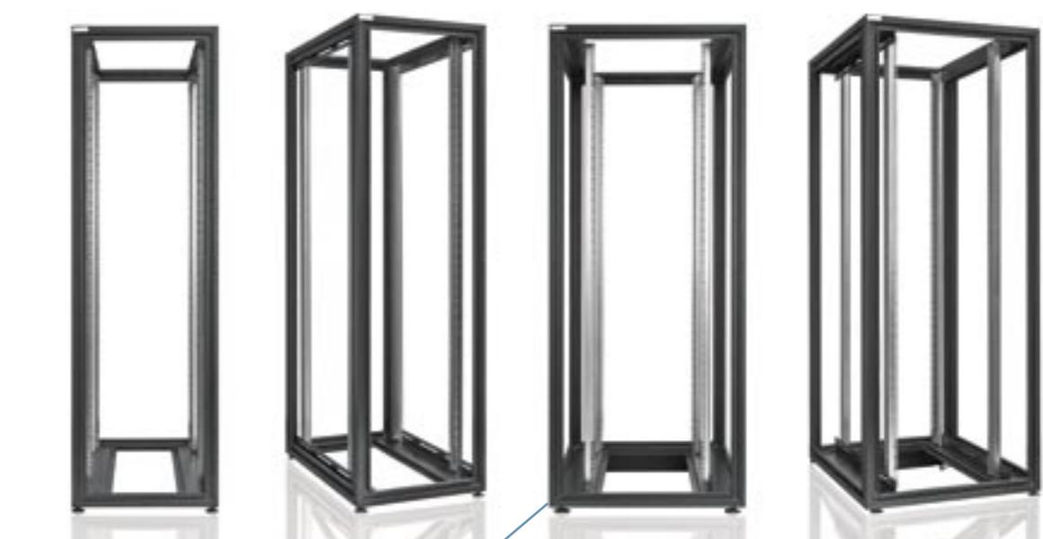
Die Basis der RZ Pro Racks stellt der verschweißte und extrem stabile Stahlrahmen in den Breiten 600 mm und 800 mm dar. Die statische Belastbarkeit beträgt 1,5 T.
