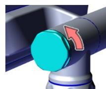
8. Stecken Sie den Rohradapter auf das Rohr. Richten Sie die Teile so aus, dass die Bohrungen in Rohr und Rohradapter übereinander liegen und die Gewindestifte wieder eingeschraubt werden können.
