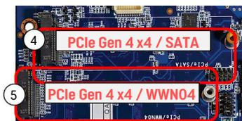
\*) Konfigurationsmöglichkeiten für die M.2-2280-Steckplätze
