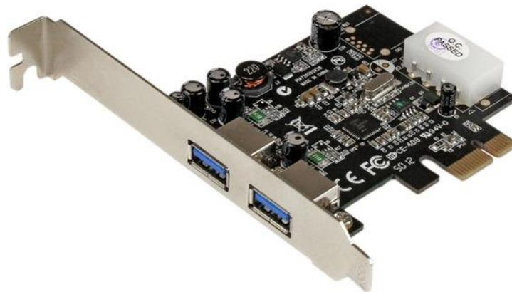
La tarjeta PCI Express USB 3.0 de 2 puertos, modelo PEXUSB3S25, le permite agregar dos puertos USB 3.0 a cualquier sistema con una ranura PCI Express disponible, al tiempo que incluye un conector LP4 opcional de alimentación eléctrica, que ofrece hasta 900 mA de potencia por puerto a los dispositivos con alimentación de bus USB 3.0 (500 mA, en el caso de USB 2.0) que conecte.
