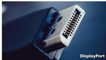
Mit dem DisplayPort-Ausgang können Sie mehrere hochauflösende Bildschirme mit nur einem Kabel über Ihr Hauptdisplay an Ihren PC anschließen. Durch die Reihenschaltung mehrerer Bildschirme erhalten Sie einen
