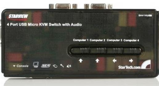
Le kit commutateur KVM USB SV411KUSB 4 ports avec audio et câbles vous permet de commander quatre ordinateurs dotés de ports USB à l'aide d'un seul ensemble clavier, souris et moniteur VGA ; il permet également le fonctionnement par touche directe et par bouton poussoir situé sur le panneau supérieur pour basculer entre les écrans connectés.
