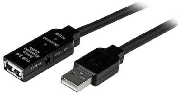
El cable de extensión USB 2.0 activo (5 metros), modelo USB2AAEXT5M, incluye un conector macho USB A y un conector hembra USB A, lo cual permite la extensión activa de dispositivos USB 2.0 en hasta 5 metros.
