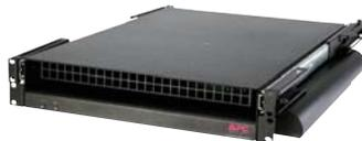
Die Rack Side Air Distribution Unit ist ein 2 HE hohes Rack-Belüftungssystem für Netzwerkgeräte oder Server mit Luftstromführung von einer Seite zur anderen. Das Gerät saugt gekühlte Luft an der Vorderseite des Racks an und leitet diese zum seitlichen Lufteinlass der Netzwerkgeräte. Diese Kühlluftführung verlängert die Lebensdauer der Geräte, da die Luft am Lufteinlass ideal temperiert ist.
