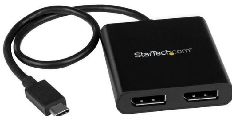
Questo hub MST USB-C a DisplayPort consente di collegare due monitor DisplayPort a un dispositivo USB Type-C Windows, offrendo un modo pratico per elevare al massimo la produttività.
