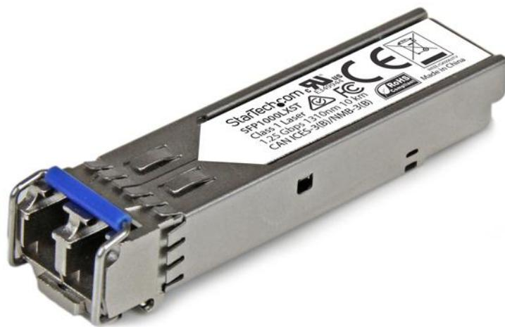
SFP1000LXST è un ricetrasmettitore SFP in fibra conforme a MSA progettato, programmato e testato con switch e router MSA compatibili con 1000BASE-LX. Il modulo ricetrasmettitore SFP supporta una distanza massima fino a 10 km e offre una connettività da 1 GbE affidabile tramite cavo in fibra.
