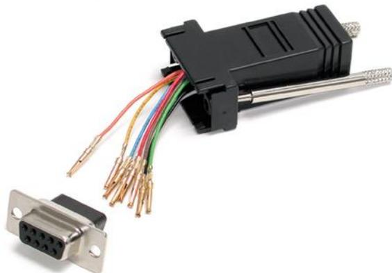
L'adattatore modulare GC98FF presenta un connettore femmina DB9 e un connettore femmina RJ45. Utilizzato per connessioni modulari RS232, RS422 e RS485, l'adattatore converte una connessione DB9 maschio in una connessione RJ45 femmina. L'adattatore permette configurazioni personalizzate dei contatti seriali.
