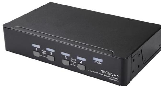
Una solución simple, pero completa. Este conmutador KVM DisplayPort de 4 puertos combina la capacidad de visualización digital 4K (60Hz) con control KVM de hasta 4 ordenadores PC conectados y con adaptadores Mini-DisplayPort; además, es compatible con ordenadores y portátiles MAC, portátiles convertibles y tablets.
