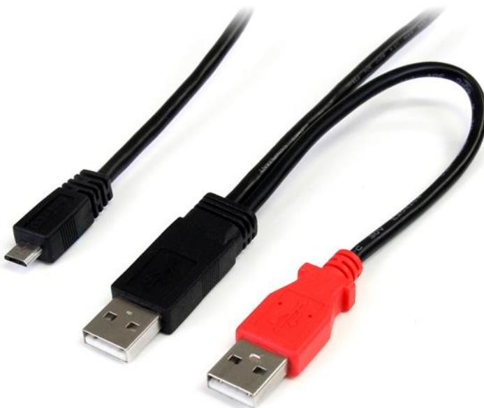
Dieses 91 cm lange USB-A-auf-Micro-B-Y-Kabel bietet 2 USB-A-Stecker und 1 USB Micro-B-Stecker und ist somit die ideale Lösung zur Bereitstellung zusätzlicher Leistung, die von einigen externen Micro USB-Festplatten benötigt wird, die an die standardmäßigen USB-Ports herkömmlicher Computer angeschlossen sind.
