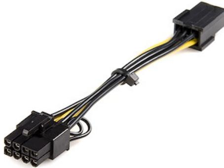
El adaptador de alimentación PCI Express de 6 pines a 8 pines, modelo PCIEX68ADAP, permite la conexión estándar de alimentación PCI Express de 6 pines de la fuente de alimentación del ordenador a las tarjetas gráficas ATI y NVidia que requieren una conexión de alimentación de 8 pines.
