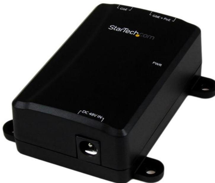
Questo iniettore Gigabit Power over Ethernet (PoE+) fornisce la connettività di alimentazione e dati a un dispositivo conforme a Gigabit PoE mediante un cavo Ethernet standard, a distanze fino a 100 m.
